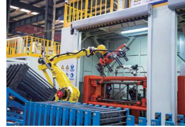
Asansör akıllı direk bölümü otomatik robot kaynak hattı
