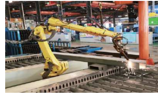
Kanal açma robotu kesme iş istasyonu
