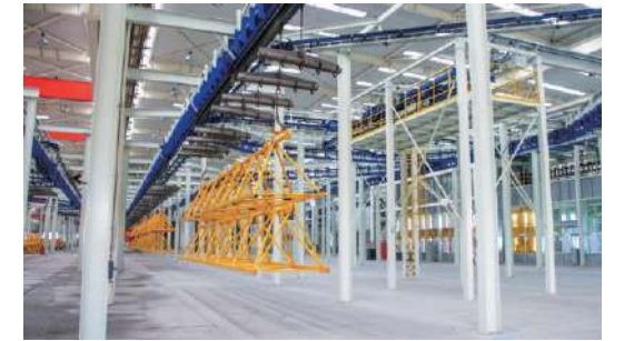
5700m ağır hizmet tipi entegre konveyör sistemi
