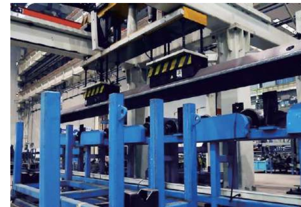
Büyük tonajlı standart direk ana kirişinin preslenmesi için özel makine
