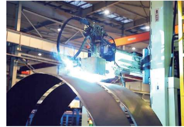
Destek alın kaynağı dikişi için kaynak makinesi
